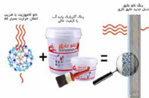
شکل ۶- دیوار پوشش داده شده با رنگ نانو عایق
